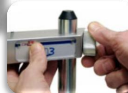
Traversa di supporto regolabile, per adeguare la posizione di lavoro all'altezza del modello
